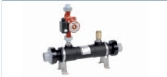
Hochwertiger Kunststoff-Wärmetauscher: bestehend aus einem Kunststoffgehäuse (Polyamid) und einer in das Gehäuse montierten Rohrwendel aus V4A 1.4571 oder Titan für Meerwasser.
