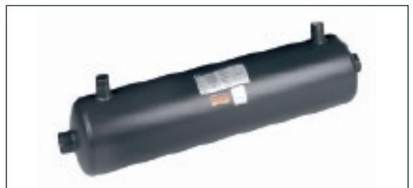
Gehäuse aus Edelstahl 1.4571, oberflächenbehandelt, zur Erwärmung des Schwimmbadwassers durch Anschluss an eine Solarthermieanlage, Wärmepumpe oder Niedertemperaturheizsystem. Bestehend aus einem Edelstahlaußenmantel mit eingeschweißter Edelstahlrohrschlange, komplett mit Tauchhülse ( $\varnothing$  15 mm x 50 mm) und Klemme zur Aufnahme
