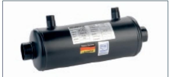
Gehäuse aus Edelstahl 1.4571, oberflächenbehandelt, zur Erwärmung des Schwimmbadwassers durch Anschluss an ein zentrales Heizsystem. Bestehend aus einem Edelstahlaußenmantel mit eingeschweißter Edelstahlrohrschlange, komplett mit Tauchhülse ( $\varnothing$  15 mm x 50 mm) und Klemme zur Aufnahme eines elektronischen Thermostatfühlers.
